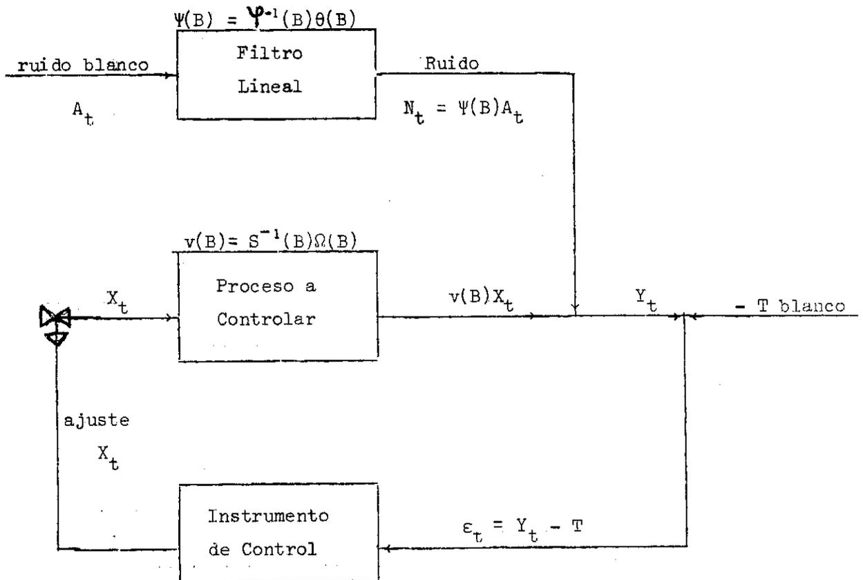
La parte superior del diagrama representa la formación del ruido a través de ruido blanco pasado por un filtro lineal. La parte media del diagrama representa la suma del ruido o interferencia con la relación dinámica entre X y Y de tal modo que produce la  $Y_t$  observada:  $Y_t = v(B)X_t + N_t$ . La etapa inferior del diagrama representa la etapa de control del proceso que se explicará a continuación.
