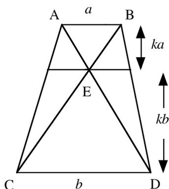
Figura 5: Segmento por la intersección de las diagonales
